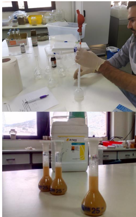
Εικόνα 7: Υπολογισμός δόσεων των εντομοκτόνων επαφής και προετοιμασία των σκευασμάτων για την εφαρμογή τους στον σπόρο.
