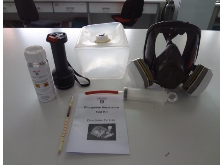
Εικόνα 1: Detia Degesch Phosphine Resistance Test Kit (DDPRTK), και σχετικά υλικά που χρησιμοποιήθηκαν για το πρωτόκολλο (Μάσκα, μετρητής φωσφίνης)
