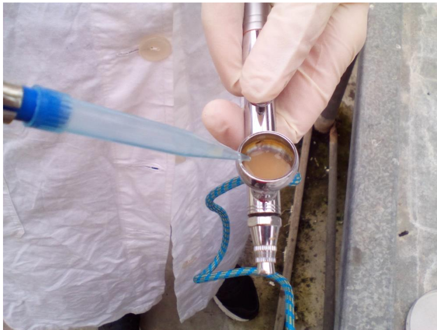
Εικόνα 9: Εισαγωγή 1ml ψεκαστικού διαλύματος με πιπέτα στον αερογράφο
