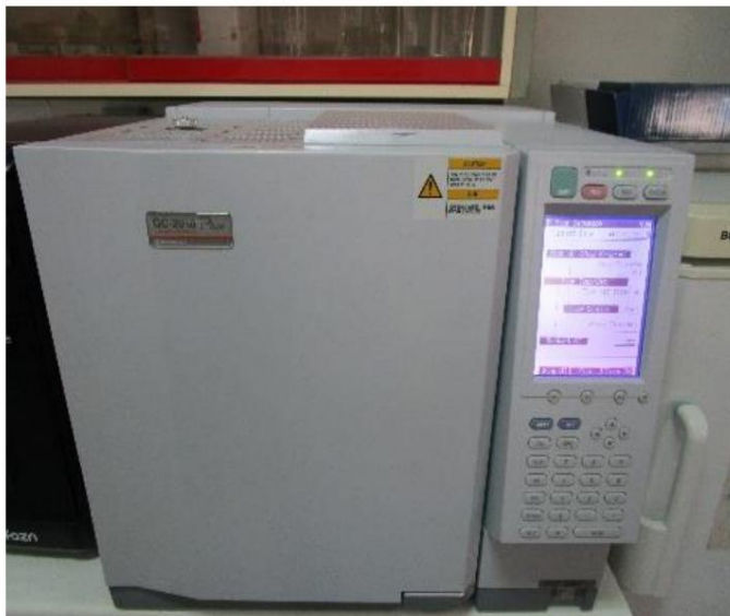
Εικόνα 4: Αέριος χρωματογράφος του Εργαστηρίου Εντομολογίας και Γεωργικής Ζωολογίας (Ε, αριστερά), εισαγωγή του αερίου στη στήλη του χρωματογράφου με ειδική σύριγγα (ΣΤ, δεξιά).
